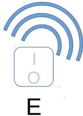
L'émetteur est alimenté par une pile plate CR2532. Il envoie des ordres par radio (allumer ou éteindre).
